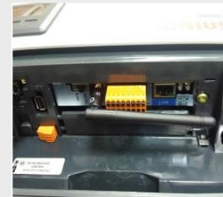
شکل ۲ - نمای از Datamanager نصب شده در زیر یک اینورتر تک فاز مدل Primo (آنتن WiFi، پورت LAN، چراغ های LED نشانگر و سوئیچ Master/Slave یا خاموش/ روشن Datamanager قابل مشاهده هستند)
